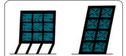
Şekil 27. Dolgu duvar süreksizliği durumunda yapının deprem davranışı
